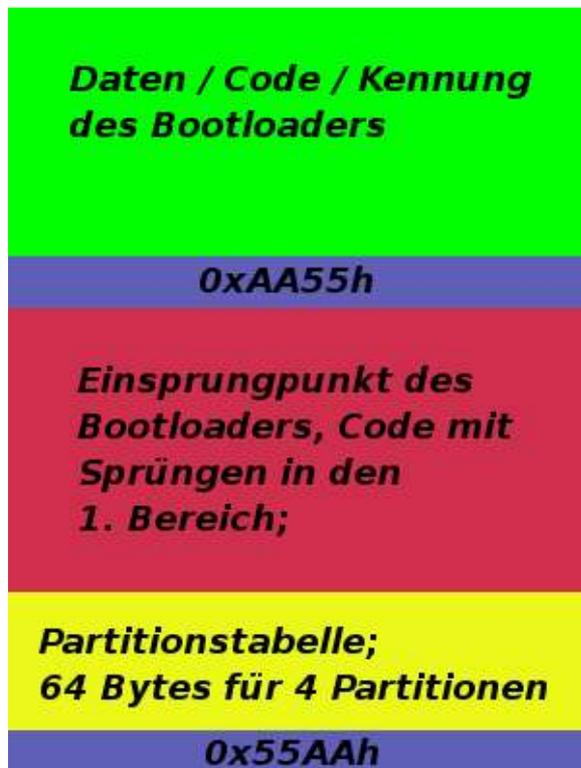
**Bild: Aufbau eines MBR**
